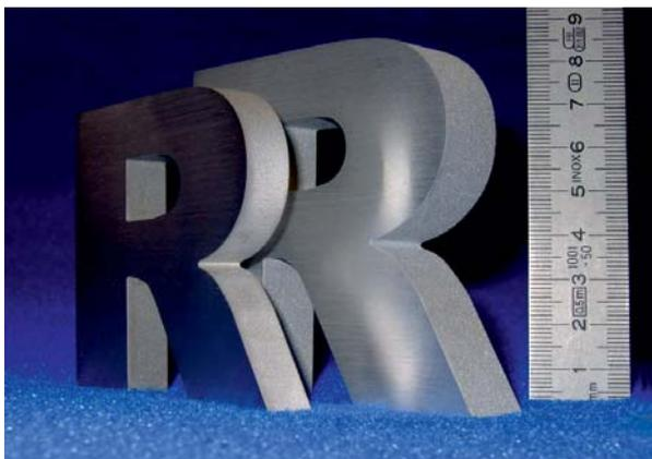
20 mm Aluminium, Kanten gesandstrahlt,
